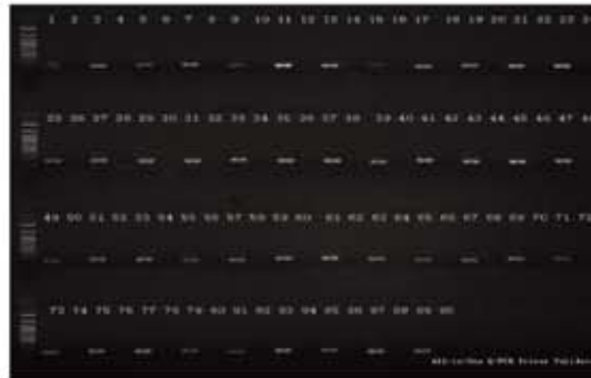
图c. qPCR扩增后进行电泳检测的示意图, 其中奇数号泳道为含cDNA样品测试结果, 偶数号泳道为对应的NTC (No Template Control)
