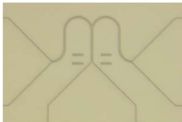
纳米流体设备可以对流经的DNA分子进行分选，找出其中的表现遗传学标志物。
